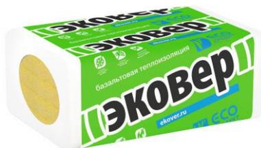
**ЭКОВЕР® ВЕНТ-ФАСАД 70** – это жесткие гидрофобизированные тепло-, звукоизоляционные плиты из минеральной ваты на основе горных пород габбро-базальтовой группы на синтетическом связующем с модифицирующими и гидрофобными добавками.
